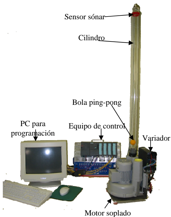
Figura 1. Vista general de la plataforma conectada a un puesto de prácticas
